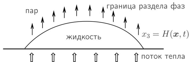
Рисунок 1 – Схема испаряющейся капли жидкости
