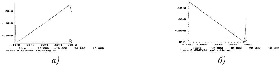
Рис.2. Распределение горизонтальной скорости  $u_x$  во входном сечении в моменты, когда она достигает максимальных значений в колебательном режиме.
