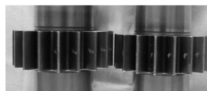
Рисунок 4 – Внешний вид шестерен с кавитационным повреждением зубьев шестерен
